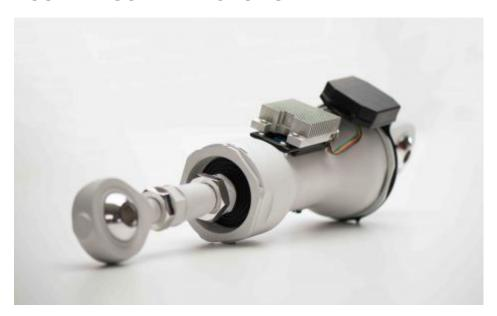
In unserem eingebetteten Benutzungs- und Zustandsüberwachungssystem überwachen Sensoren, die an Frequenzadaptern für Helikopter angebracht sind, Distanz, Kraft, Druck und Temperatur. Die Daten werden während des Flugs analysiert und gespeichert. So können der Zustand der Komponenten beurteilt und Daten zu tatsächlichen Betriebsbedingungen gespeichert werden.
