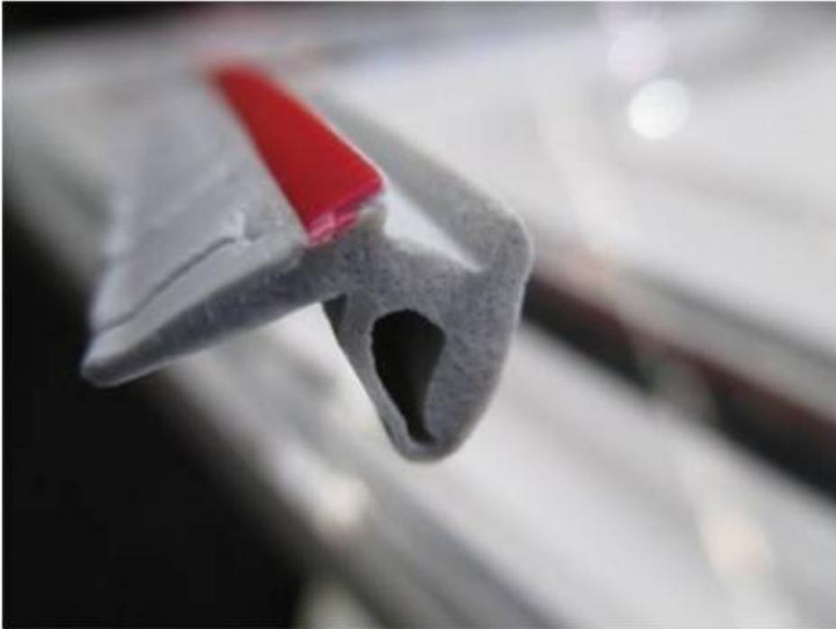
Unsere Innenverglasungslösungen sind für die Innenscheiben von Aluminiumtüren und -fenstern von Gebäuden konzipiert. Sie gewährleisten einen konstanten und nachhaltigen Druck auf die Doppelverglasung, um die Dichtung an der Außenscheibe wirksam zu komprimieren und die Fenster luftdicht zu halten. Wir wenden für unsere Trockendichtungen, die mit selbstreinigenden Fenstern kompatibel sind, keine Oberflächenbehandlungen an.
