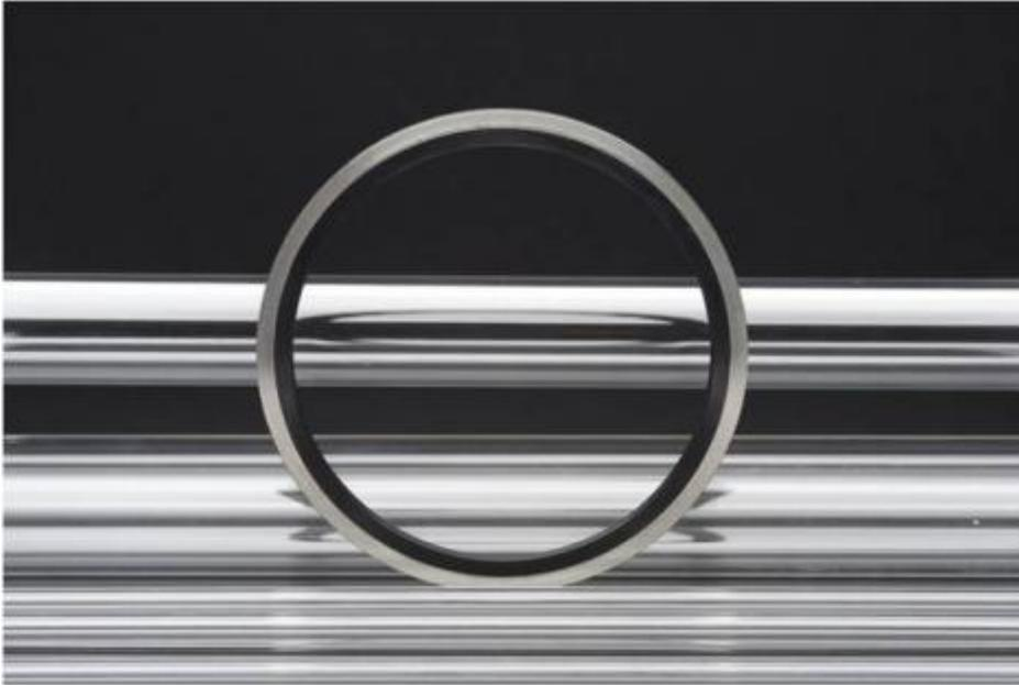
Die BS-Dichtung besteht aus einem Metallring mit einem innen anhaftenden, anvulkanisierten Dichtprofil aus Gummi. Entwickelt wurde die BS-Dichtung für Anwendungen, in denen unter extremen Temperaturverhältnissen Beständigkeit gegenüber Druck und gleichzeitig gegenüber Vibrationen gefordert ist. BS-Dichtungen bieten eine breite Palette von Anwendungen im Bereich der mediumführenden Systeme wie Kraftstoffe, HVAC, Hydraulik und Pneumatik.
