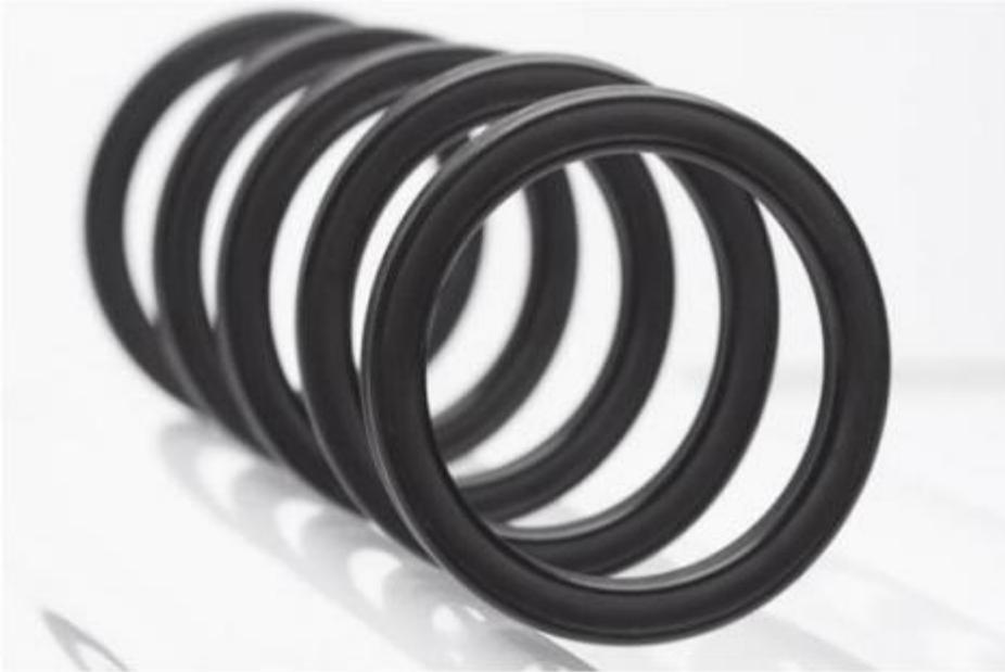
JF4-Ringe (X-Ring) weisen im Querschnitt ein Vierlippenprofil auf und bieten so eine doppelte Dichtfunktion. Wie bei O-Ringen gibt es keine bestimmte Montagerichtung.
