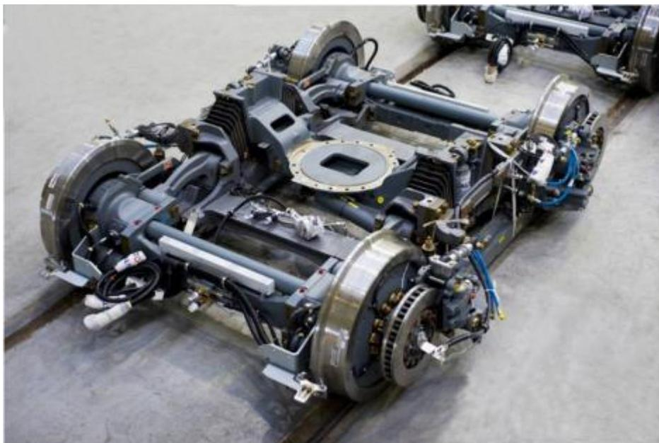
Notre solution globale se compose de suspensions primaires, de suspensions secondaires, d'articulations lamifiées, de butées, et de sommiers. Elle assure la stabilité du train sur les voies et la filtration des vibrations pour améliorer le confort des passagers.
