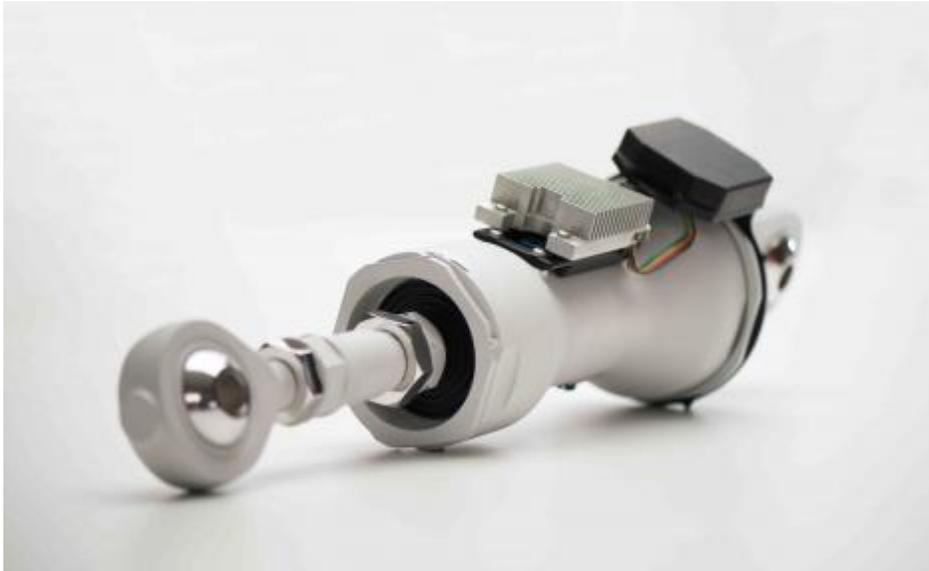
Avec notre système intégré de mesure et d'évaluation, des capteurs embarqués sur les adaptateurs de fréquence pour hélicoptères mesurent le déplacement, l'effort, la pression et la température. L'enregistrement et l'analyse des données se fait en vol. Ceci permet d'évaluer la santé de la pièce et d'enregistrer les conditions réelles d'exploitation.
