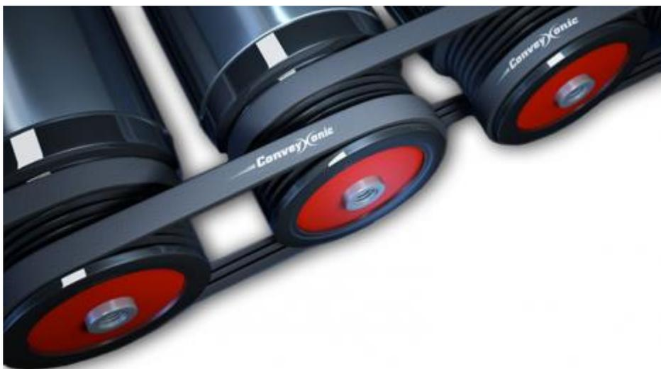
Notre courroie ConveyXonic® avec câblé élastique transmet la puissance depuis le rouleau moteur vers les rouleaux esclaves du convoyeur. Obtenue par moulage, cette solution bénéficie d'une qualité optimale et propose une durabilité qui limite fortement les frais de maintenance. Elle permet de diminuer le coût global du convoyeur en réduisant le nombre de rouleaux moteurs.
